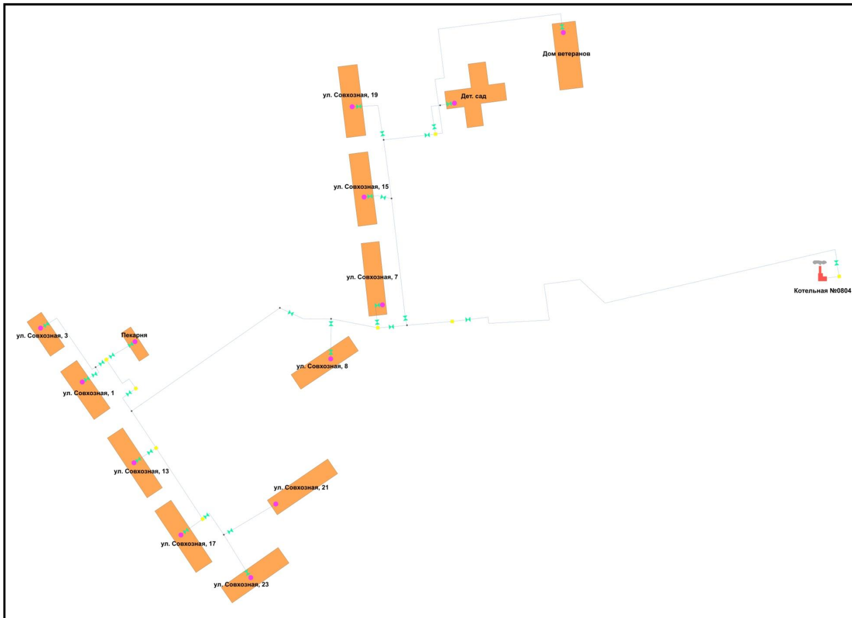
Рис.2 - Карта тепловых сетей в зоне действия котельной №0804
