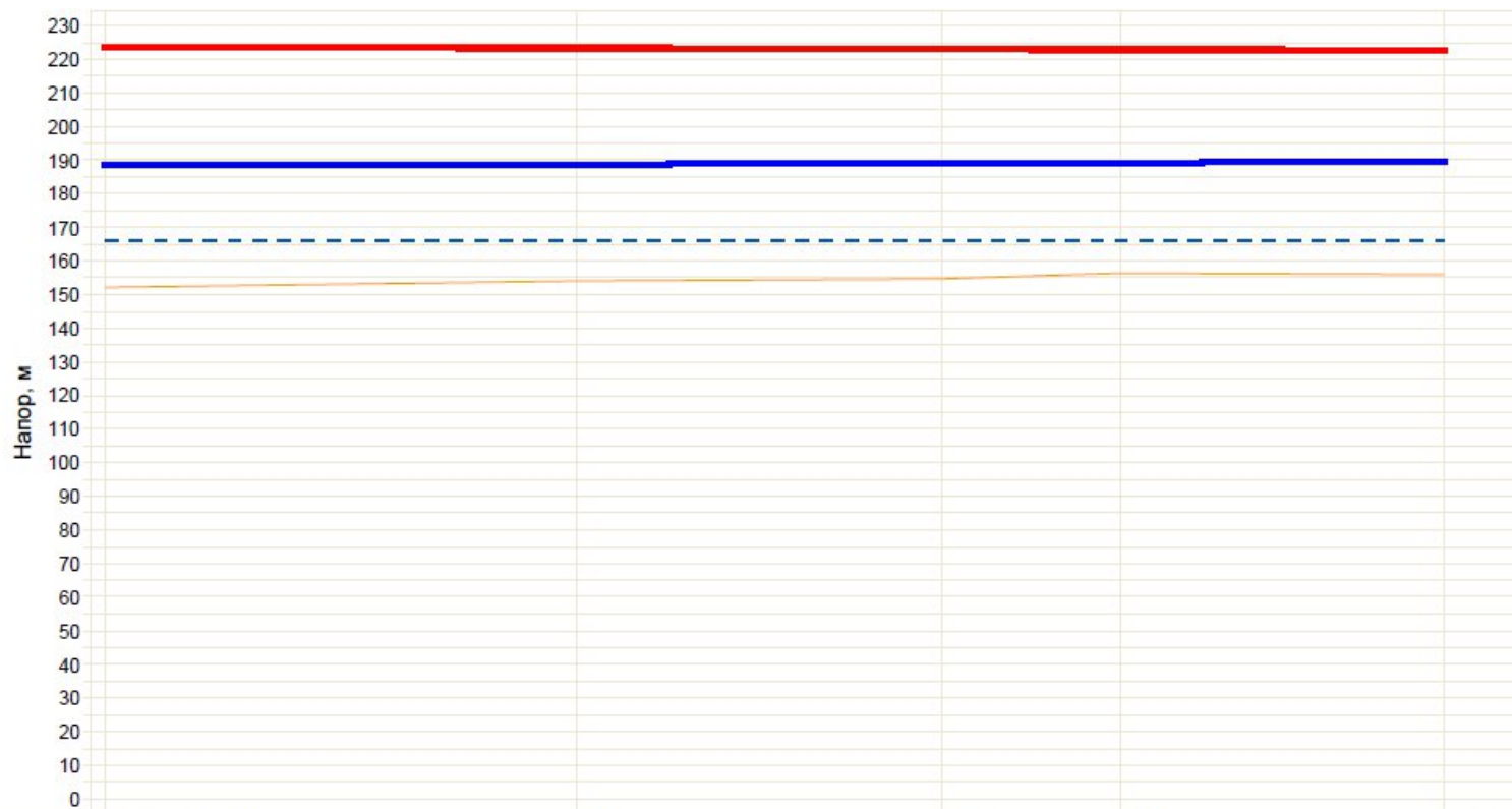
Пьезометрический график от «Котельная 1402» до «д/с»
