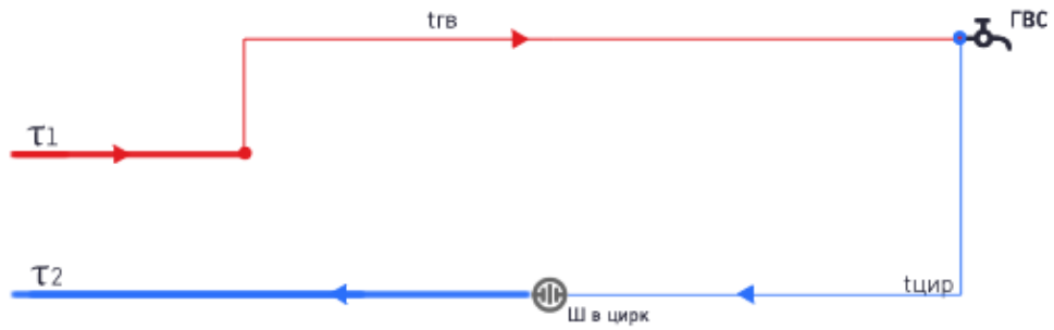
Рис. 1.8. Схема присоединения системы горячего водоснабжения потребителей по четырехтрубной схеме теплоснабжения.
